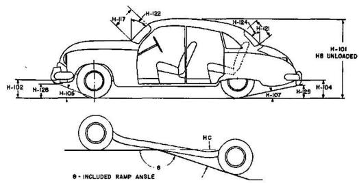
HC-RAMP BREAKOVER ANGLE (SUPPLEMENT OF INGLUDED RAMP ANGLE)
