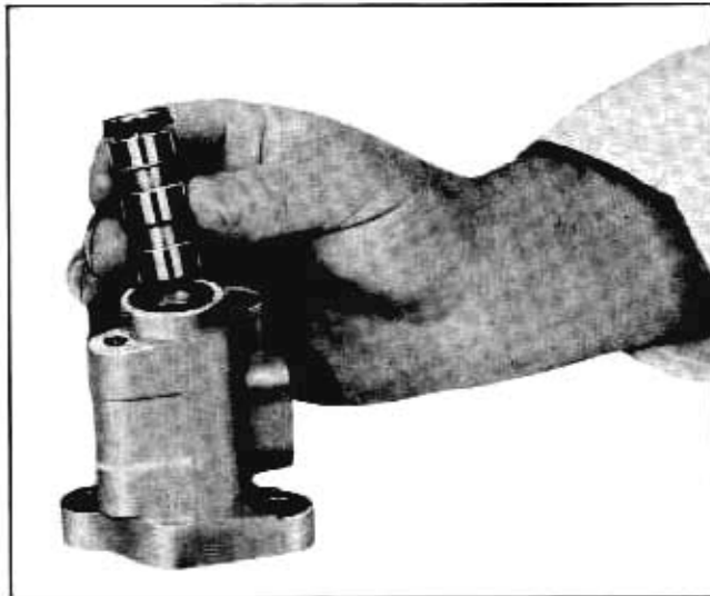
Fig. 9A-35 Removing Valve Spool
