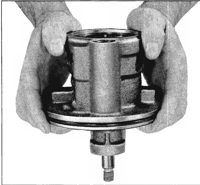
Fig. 9A-43 Removing Pump Shaft
