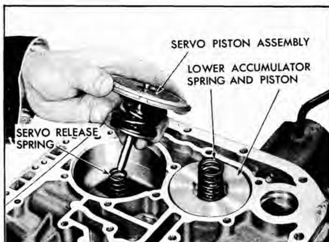
Fig. 135 Installing Servo Piston
