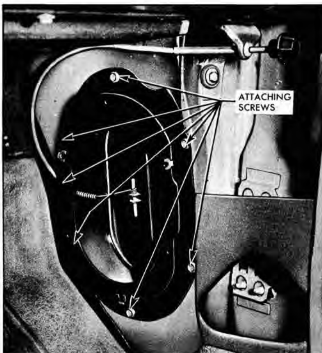
Fig. 12-24 Air Outlet Door
