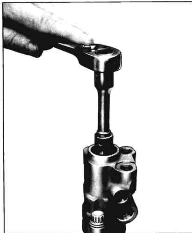
Fig. 9A-29 Removing Adjusting Nut
