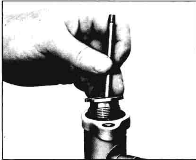
Fig. 9A-44 Installing Adjuster Plug
