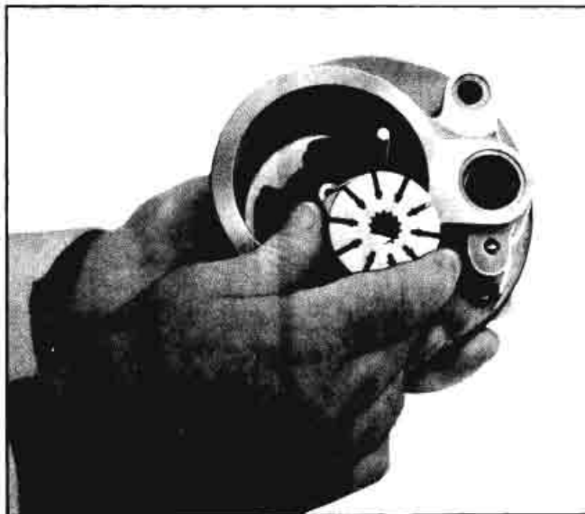
Fig. 9A-17 Installing Rotor
