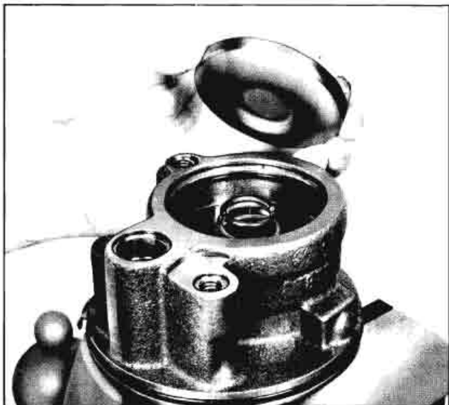
Fig. 9A-9 Removing End Plate
