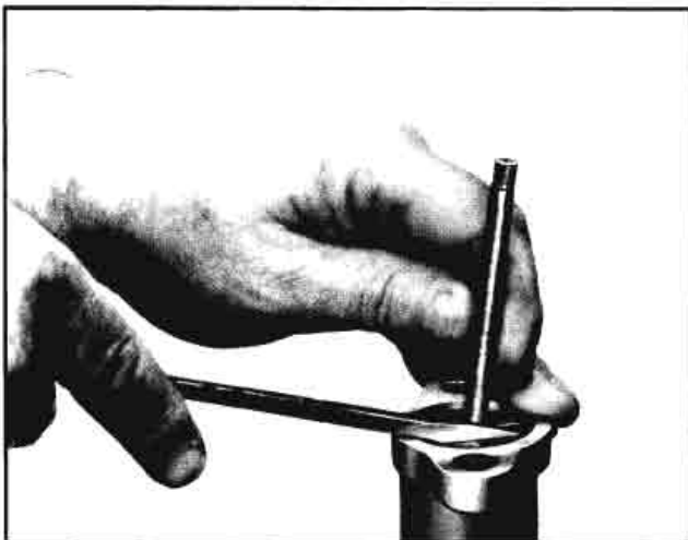
Fig. 9A-37 Removing Adjuster Plug
