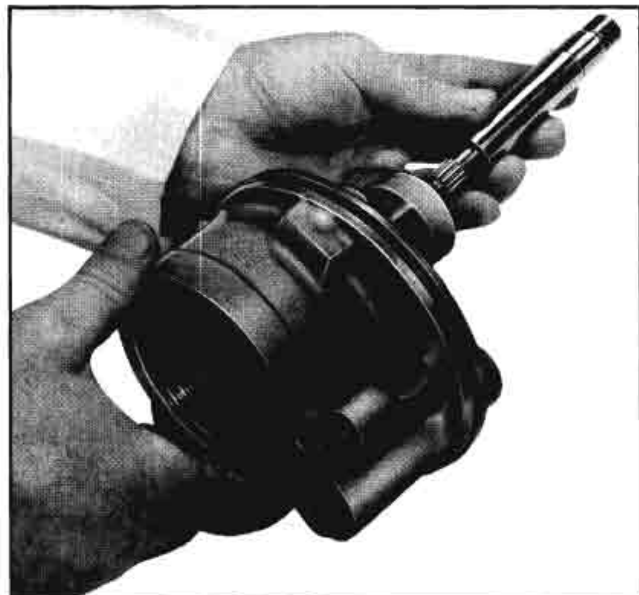
Fig. 9A-13 Removing Pump Shaft
