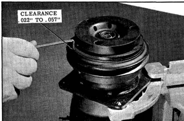
Fig. 14-86 Checking Air Gap
