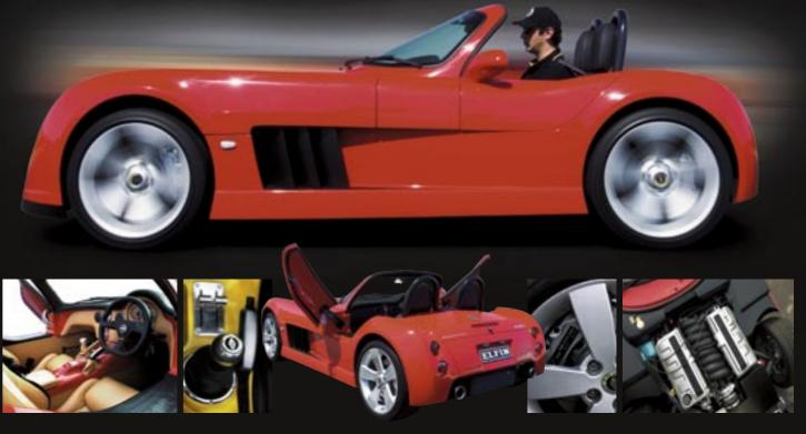
> 0-100~4.4~sec~> 5.7~Litre~V8~> 245kW~> 4.5kg~per~kW~> 465Nm~> 1100kg~> 6-speed
